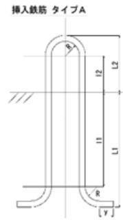
・挿入鉄筋(丸鋼)
