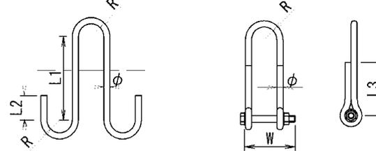
●連結鉄筋（フック）・連結金具（シャックル）寸法表
