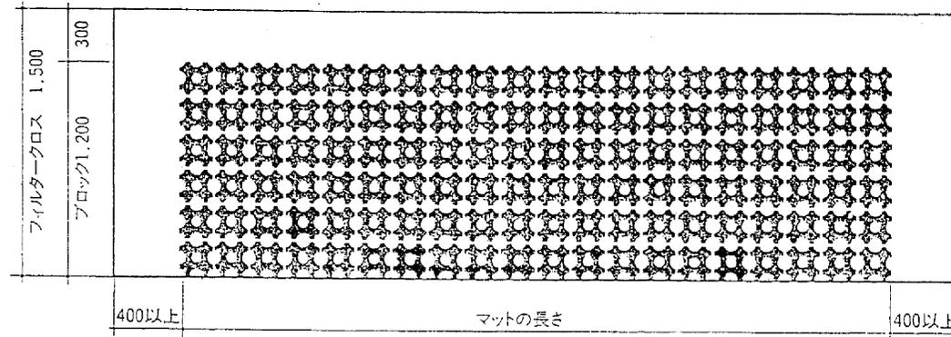
※幅は標準サイズですが、長さは、設計に応じて2.0m～8.0mの間で調整できます。
