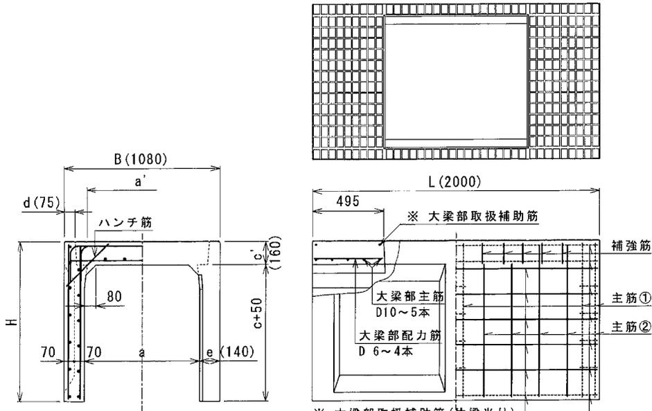
※ 大梁部取扱補助筋(片梁当り)
